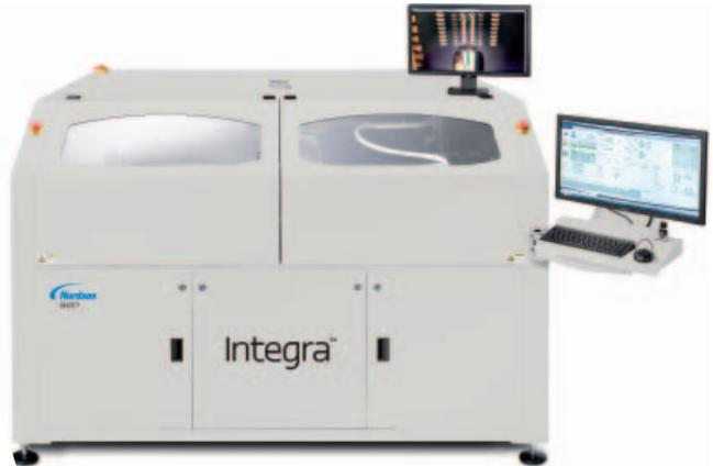
Die besonders robusten Titan-Löttiegel können mit allen Lötlegierungen, mit und ohne Blei, umgehen. Die Löttiegel sind serienmäßig mit vorgeheizter Stickstoffbegasung ausgestattet, welche Krätze und Oxidation minimiert. Eine Pumpe aus Titan stellt ein gleichmäßiges, schwankungsfreies Strömen des Lötmittels sicher. Das Ergebnis ist eine sehr gleichförmige Lötwellen. Ihre Höhe wird über den Pumpenmotor eingestellt und mittels Wellenhöhenüberwachung permanent kontrolliert und ggf. korrigiert.
